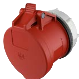
Presà da pannello RAPIDO senza viti, con TwinCONTACT, fissaggio centrale, per fori di fissaggio diam. 70 mm
