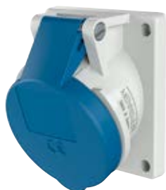
Presà da pannello senza viti, con TwinCONTACT, flangia 16 A, 3 p: 73,5 x 64 mm, 6 A, 4 + 5 p, 32 A: 100 x 92 mm, inclinazione a 20°, 32 A: può essere dotata di contatto ausiliario
