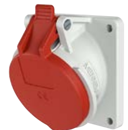
Preso da pannello flangia standard dimensioni 85 x 85 mm, inclinazione a 20°, può essere dotata di contatto ausiliario
