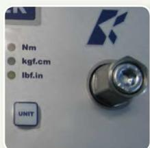
Il controllo della coppia di serraggio è di vitale importanza per garantire la qualità dell'assemblaggio dei propri prodotti. Giunzioni che non sono sufficientemente serrate possono vibrare, mentre una coppia eccessiva può danneggiare il filetto o i componenti da assemblare. L'utilizzo di un misuratore di coppia di qualità è diventato sempre più importante per molte aziende per garantire il serraggio applicato.
